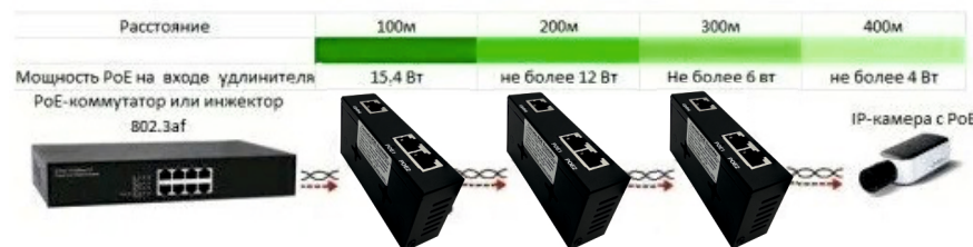
Рис. 4 Зависимость передаваемой мощности от расстояния передачи
